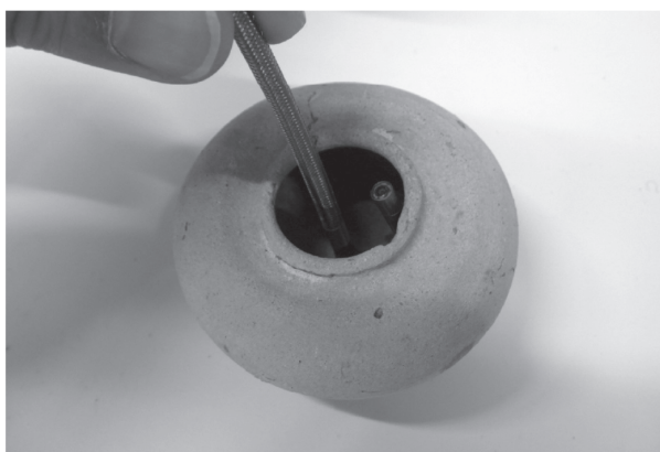
図8 ファイバースコープの可動域の限界
